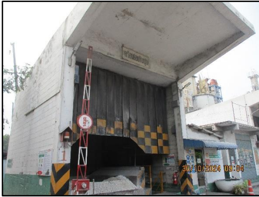
ภาพที่ 2.40 อ่างรับวัตถุดิบที่มีม่านยางป้องกันการฟุ้งกระจายของฝุ่นละออง
